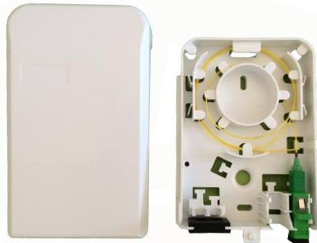
La roseta de abonado de fibra óptica TLX-22.00 se utiliza como punto de terminación del cable de acometida óptica en viviendas y oficinas. El acceso a la misma se puede realizar por diferentes zonas: inferior, lateral y trasera. Dispone así mismo de diferentes puntos para la sujeción del cable de acceso mediante bridas.
