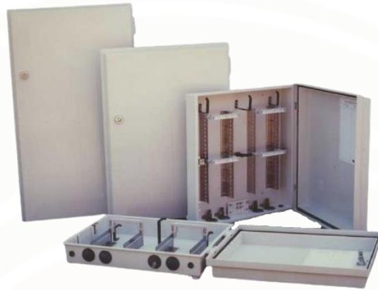
Las cajas de conexiones SERIE 31 se utilizan principalmente en planta exterior bien sobre fachada o poste, alojando en su interior las regletas necesarias para la interconexión de los cables telefónicos. Dado las diferentes regletas de conexión existentes en el mercado, las cajas se suministran con los soportes adecuados para cada una de ellas. Igualmente van equipadas con sus correspondientes conos para entrada/salida de cables, piezas de sujeción y anillas guía-hilos.
