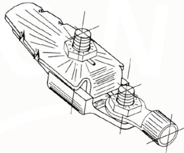
El conjunto de continuidad de pantalla tipo “cocodrilo” se utiliza para dar continuidad a las pantallas de los cables de pares en las operaciones de empalme o finalización en repartidores, armarios de distribución, etc.
