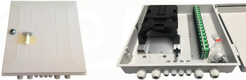
Los armarios terminales de empalme y repartición de fibra óptica SERIE 38 se utilizan como punto de almacenamiento de hasta 64 empalmes distribuidos en cuatro bandejas abatibles, así como su posterior repartición. Su configuración es tal que se puede utilizar tanto en el interior de edificios como en planta exterior, ya que las entradas y salidas de cables son mediante prensaestopas.
