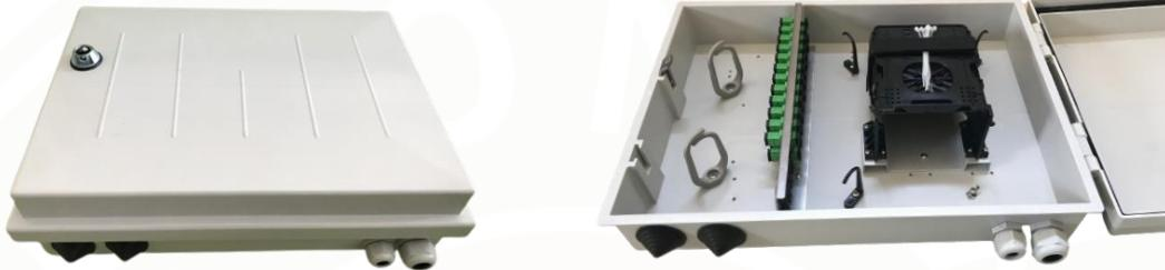
Las cajas de distribución y empalme F.O. TLX-40.30 se utilizan como punto de terminación de cables de fibra óptica y su segregación mediante pigtaills. Su constitución permite el almacenamiento de los empalmes en 6 bandejas apilables y su posterior repartición. Existen varios modelos de repartidores para el alojamiento de los adaptadores, cuyas capacidades van desde los 24 hasta los 72 SC.
