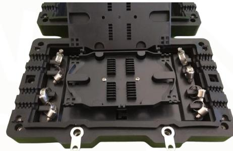
Este torpedo de empalme horizontal en línea estanco para fibra óptica TLX-69.11, se utiliza como protector y almacenamiento de los empalmes de fibra óptica, mediante un máximo de 2 bandejas de empalme alojadas en su interior, cada una de ellas con capacidad para alojar hasta 24 empalmes por fusión.
