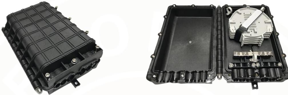
La caja de empalme 96 F.O. TLX-69.14/96, se utiliza como protector y almacenamiento de los empalmes de fibra óptica. Puede alojar hasta un máximo de 96 empalmes en su interior repartidos en 4 bandejas de 24 F.O. Cuenta con un grado IP-68 contra la intemperie.
