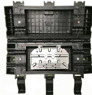
Este torpedo de empalme horizontal para fibra óptica TLX-69.19, se utiliza como protector y almacenamiento de los empalmes de fibra óptica. Puede alojar hasta un máximo de 12 empalmes en su interior. Debajo de las bandejas lleva un soporte para poder montar hasta 2 adaptadores tipo SC.
