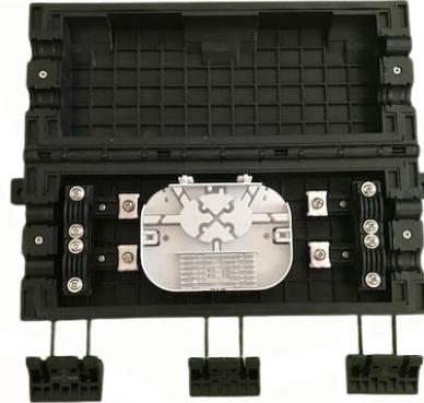
Este torpedo de empalme horizontal para fibra óptica TLX-69.20, se utiliza como protector y almacenamiento de los empalmes de fibra óptica. Puede alojar hasta un máximo de 24 empalmes en su interior. Debajo de las bandejas se pueden alojar hasta 4 adaptadores tipo SC.
