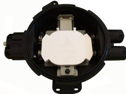
La caja de empalme estanca 36 fibras ópticas de la serie 69 TLX-69.04 puede ser utilizada en arquetas de pequeñas dimensiones, facilitando el trabajo de la fibra óptica, siendo además fácil de abrir y cerrar dado que no necesita tornillos para lograr su estanqueidad. Igualmente, esta caja de empalme, puede utilizarse tanto en poste como en fachada.
