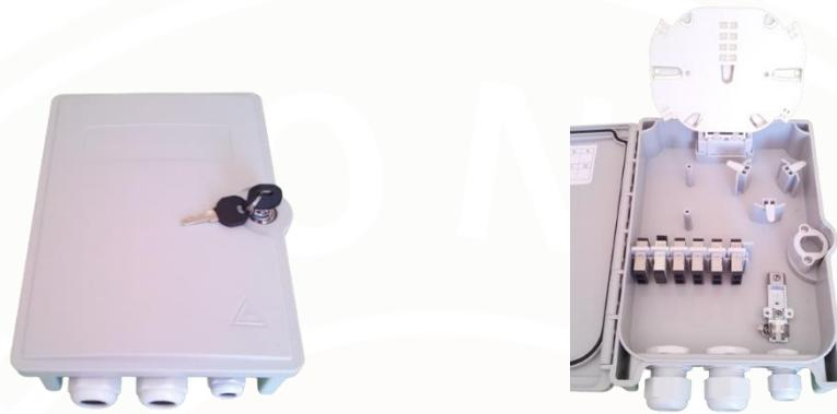
La caja de distribución y empalme para 12 fibras ópticas TLX-72.01 ofrece una solución flexible para aplicaciones tanto de interior como de exterior. Dispone de alojamientos para 6 adaptadores tipo SC duplex así como para un divisor tipo PLC 1x4/1x8 situado bajo la zona de giro de la bandeja porta empalmes. Esta bandeja es abatible a fin de permitir la organización y manejo de las fibras y tiene una capacidad máxima de 12 empalmes por fusión.
