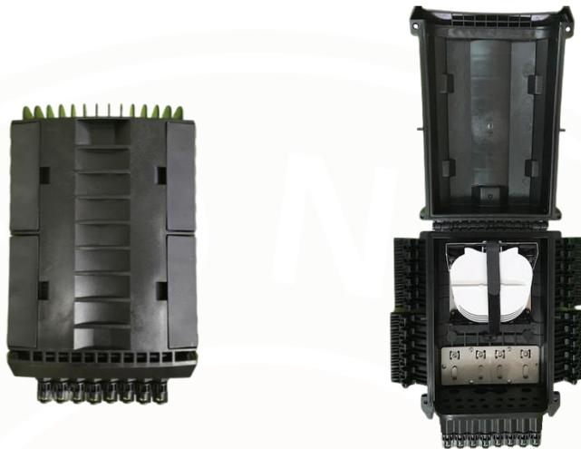
La caja terminal de exterior 16 F.O. IP-68 TLX-78.01 está diseñada para ofrecer una manipulación de apertura y cierre sin tornillos mediante unas sencillas alas laterales. En su interior se alojan 4 bandejas porta empalmes, con 24 F.O. de capacidad cada una, abisagradas en una de sus caras, lo cual facilita las operaciones en ellas. Estas bandejas permiten la instalación de PLC splitters. Además de las bandejas para fusión la caja cuenta con un repartidor con capacidad 16 adaptadores SC.
