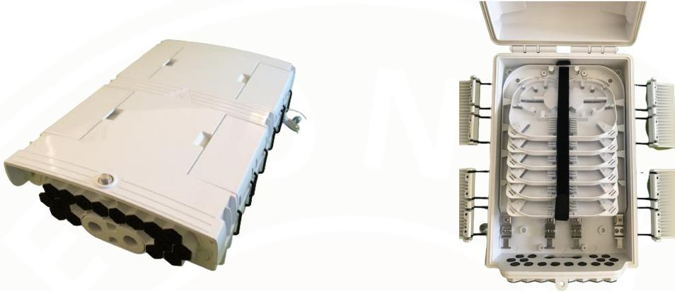
La caja exterior de empalme 72 F.O. TLX-78.14 está diseñada para ofrecer una manipulación de apertura y cierre sin tornillos mediante cuatro sencillas alas laterales. En su interior se alojan 6 bandejas porta empalmes de 12 fibras ópticas, abisagradas en una de sus caras, lo cual facilita las operaciones en cada una de ellas. Estas bandejas permiten la instalación de PLC splitters.
