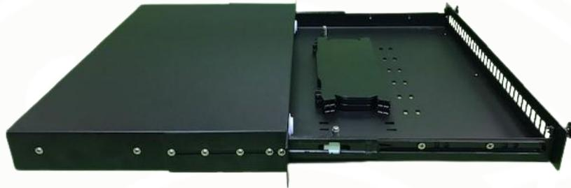
Los repartidores ópticos o bandejas de distribución para fibra óptica SERIE 65 se utilizan generalmente en racks de 19" ocupando 1U de altura. El panel frontal es intercambiable con posibilidad de montar un frontal de 24 SC simplex, 32 SC simplex, 24 SC dúplex (48fo) o 32 SC dúplex (64fo).
